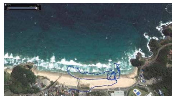
GPS(全地球測位システム)被験者による海浜流の計測結果の例 / 海水の流れや波の状況を測ることで自然のメカニズムを学ぶ。特に、溺水事故の主要因である離岸流(海岸の波打ち際から沖合に向かって生まれる潮流)を計測する。
